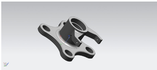
Рисунок 1. — Пример детали со сложной геометрией, изготавливаемой на фрезерном станке с ЧПУ
