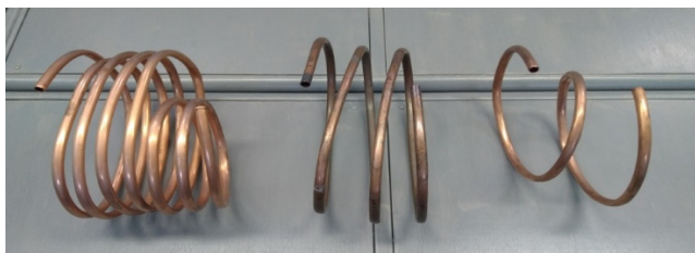
Рис. 4 – Внешний вид теплообменников с различной площадью поверхности
