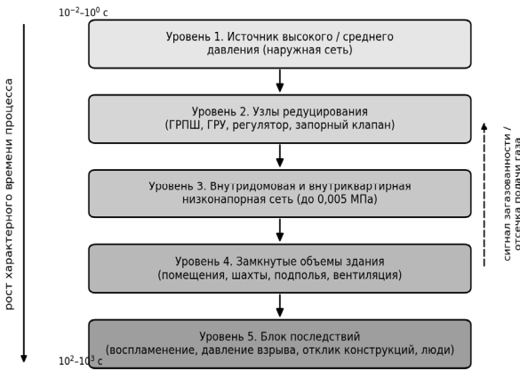
Рис. 1. Структурная схема динамической декомпозиции газовой системы жилой застройки
