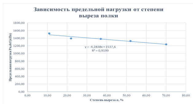
Рисунок 4. Зависимость предельной нагрузки от степени выреза полки P_{u,def} = f(\alpha)
